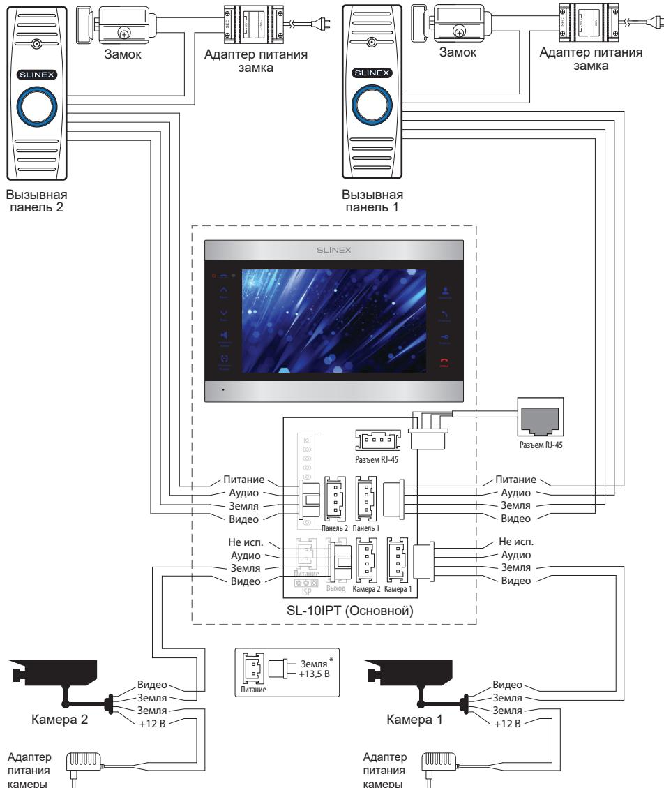
Схема 2. Подключение системы домофонов SL-10IPT и SL-07M.
